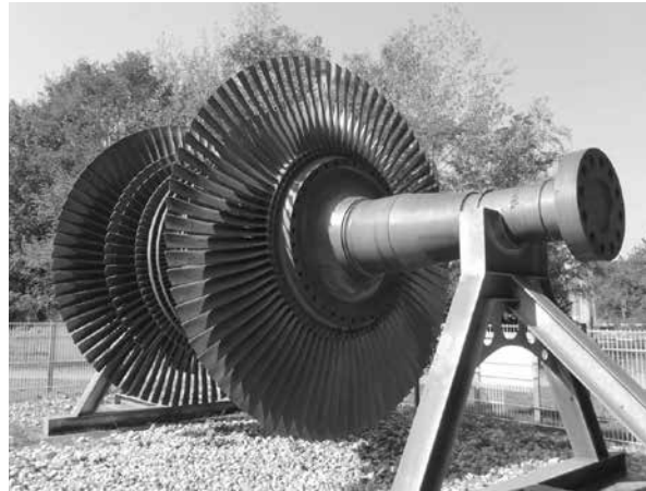
32 Niederdruckdampfturbinenläufer aus Block D des Braunkohlekraftwerks Schwandorf/Dachelhofen, in Betrieb von 1972 bis 2002, ausgestellt in Wackersdorf.
